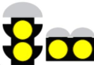
**Amarela intermitente:** tem a função de advertir sobre a existência de obstáculo ou situação perigosa, devendo o condutor reduzir a velocidade e adotar as medidas de precaução compatíveis com a segurança para seguir adiante.
